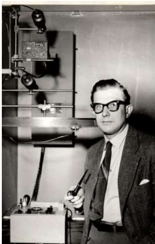
Kuva 2. Hans Blomberg ja väitöskirjatyönä konstruoitu magneettivuon mittaajajärjestelmä
